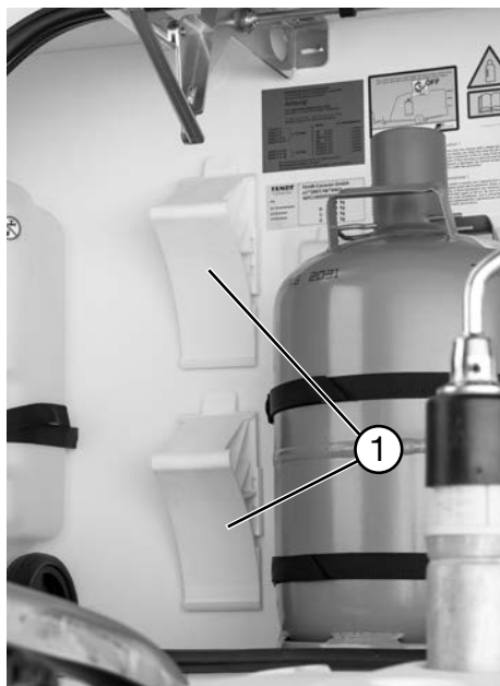
Hjulkile i gasskassen
