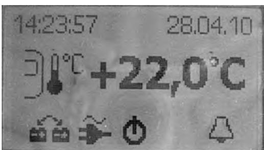
**Menü Anzeige Außentemperatur (beleuchtet, Betrieb ohne Batteriesensor)**
