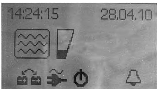
**Menü Tankanzeige (beleuchtet, Betrieb mit und ohne Batteriesensor)**
