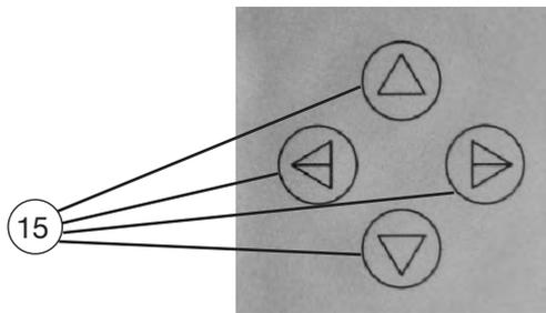
Mit den Navigationstasten 15 „Rechts“, „Links“, „Hoch“ und „Runter“ können verschiedene Anzeigen im Display 14 aktiviert werden und es können verschiedene Einstellungen vorgenommen werden. Mit den Tasten „Rechts“ und „Links“ bewegt man sich zwischen den einzelnen Menüs. Mit den Tasten „Hoch“ und „Runter“ werden verschiedene Parameter eingestellt.
