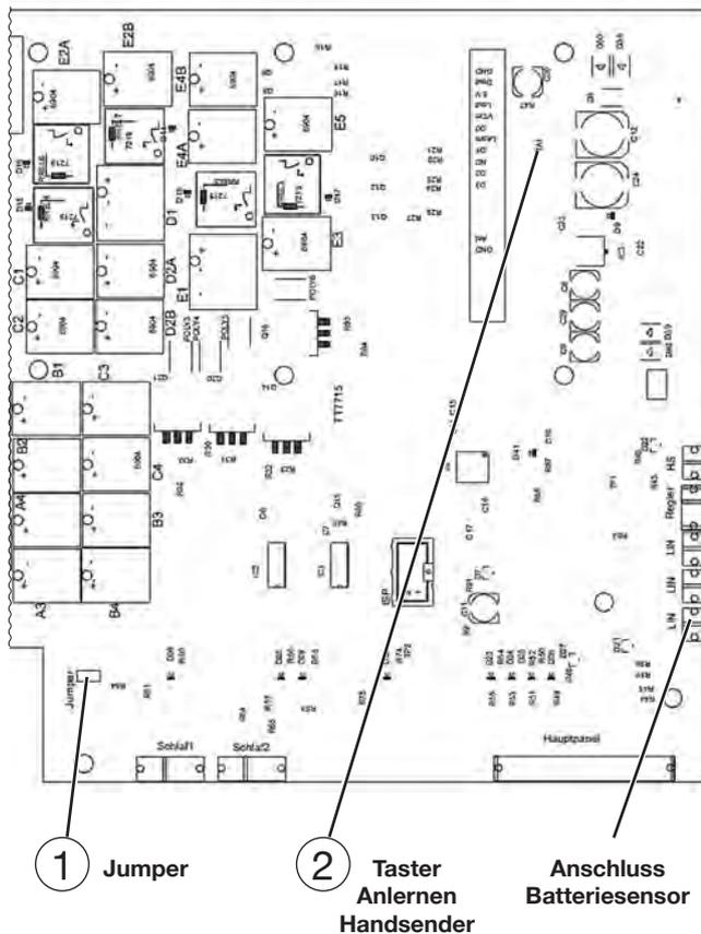
Beim Einbau einer Batterie im Caravan muss die Stellung des „Jumper“ ① geändert werden. Im Autarkbetrieb muss die Brücke auf den beiden Steckpfosten so gesteckt werden, dass diese beiden elektrisch verbunden sind. Wenn diese Umstellung erfolgt, ist es möglich im Batteriebetrieb alle Verbraucher einzuschalten.
