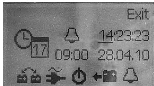
In diesem Menü bewegt man sich mit den „Rechts“ und „Links“ Tasten zu den verschiedenen Einstellwerten. Der gerade angewählte Wert wird durch die blinkende Unterstreichung des Wertes gekennzeichnet. (In dem gezeigten Beispiel die aktuelle Stunde von 14 Uhr). Mit den Tasten „Hoch“ und „Runter“ werden die Werte geändert. Betätigt man die Taste „Hoch“ oder „Runter“, wenn die Unterstreichung von „Exit“ erfolgt, wird das Menü verlassen.
