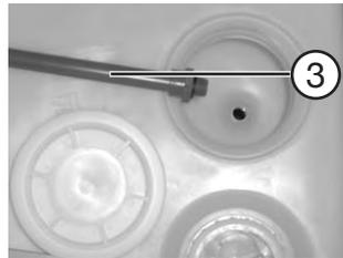
Bei Überfüllung des Tankes tritt das überschüssige Wasser mittels eines Überlaufs unter dem Fahrzeugboden aus.
