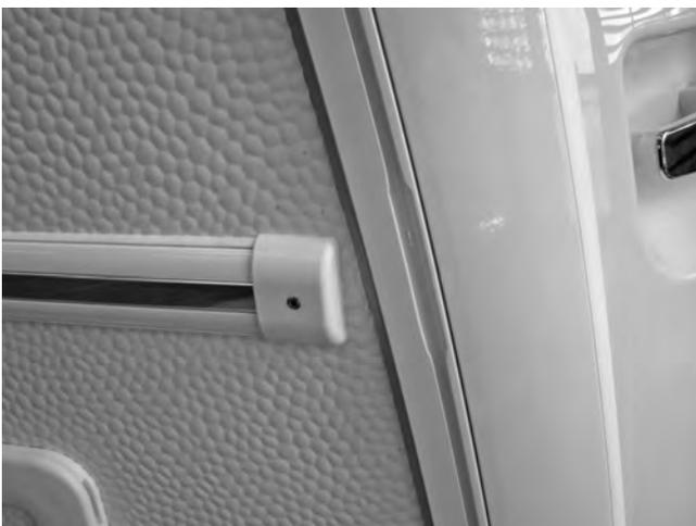
Die Vorzeltleiste ist zum Einführen des Zeltkeders am Heck / Bug in Höhe der Zierleiste ausgefräst.
