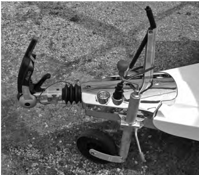
Der Caravan ist mit einer Antischlingerkupplung ausgerüstet nach ISO11555-1. Diese Sicherheitskupplung stabilisiert den Caravan während der Fahrt und sorgt damit für ein besseres Fahrverhalten.
